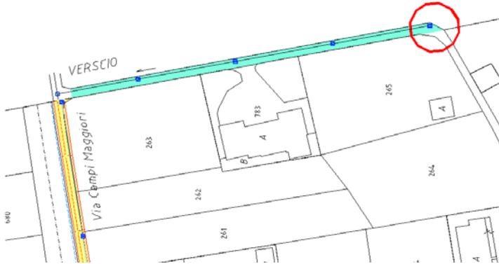
In tempi recenti si è constatato che l'evacuazione delle acque stradali è carente. In particolare in caso di pioggia si formano delle pozze d'acqua, soprattutto in corrispondenza della curva indicata con il cerchio rosso.
