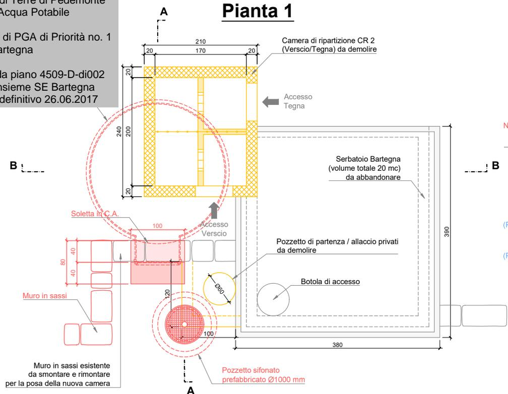
Muro in sassi esistente da smontare e rimontare per la posa della nuova camera
